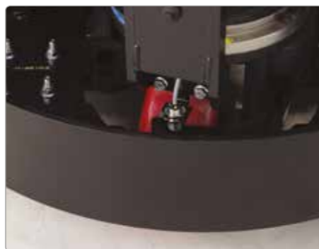
Yale Smart Slow Down™-sensoren registrerer automatisk markante drejninger og justerer trucken derefter.
